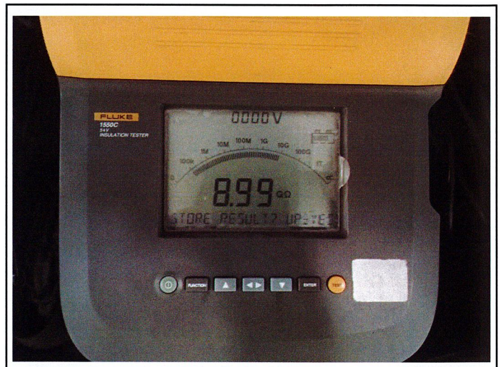
ตรวจวัดค่าความต้านทานฉนวนของขดลวดหม้อแปลงไฟฟ้าแรงสูง
