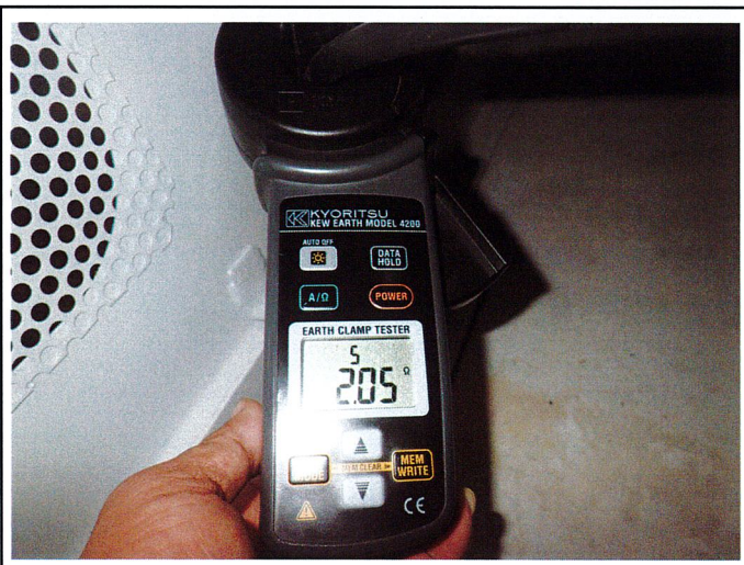
ตรวจวัดค่าความต้านทานดินของหม้อแปลงไฟฟ้า
