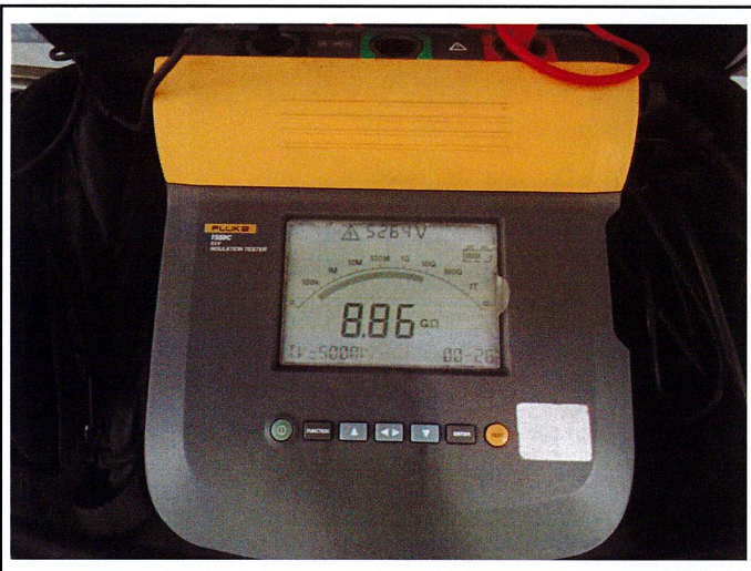
ตรวจวัดค่าความต้านทานฉนวนของขดลวดหม้อแปลงไฟฟ้าแรงสูง
